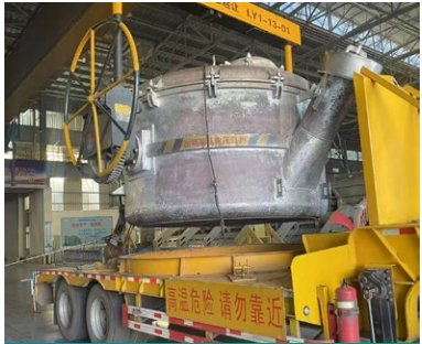
「鋁水直供不落地」模式現場照片
